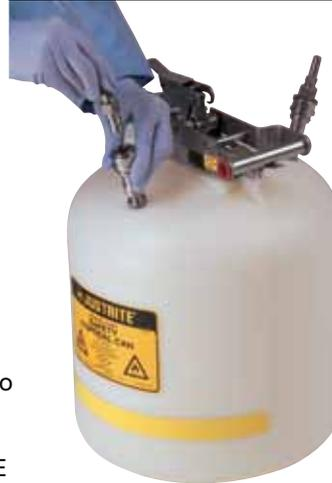
Quita y pon es la clave del exclusivo sistema de "desconexión rápida" de Justrite. El mecanismo ofrece la simple desconexión del bidón del proceso, sin fugas, goteo o liberación de vapores. Cuando se desconecta, el recipiente queda sellado automáticamente para evitar derrames y el mango del transporte fácil ayuda a transferir el contenido a la estación de desecho.
